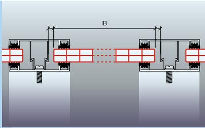
**4** | Die lichte Breite bzw. die Plattenbreite (B) von Makrolon® multi UV Platten ergibt sich aus dem Sparrenabstand, den Abmessungen des gewählten Profils und dem notwendigen Dehnungsspiel (3 mm/m bei Polycarbonat).
