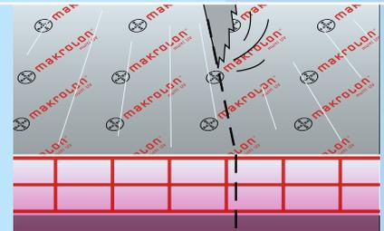
**8** | Werden die Makrolon® multi UV Platten in ihrer Breite reduziert, sägen Sie bitte möglichst nahe am nächsten Steg, um die optimale Klemmwirkung des Profils zu gewährleisten.
